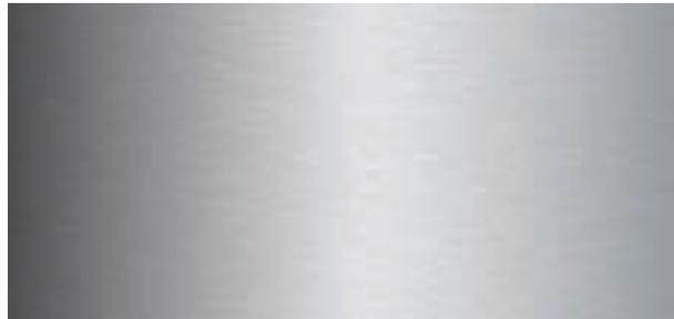
Покрытие – «хром сатин тисненый» - многослойное гальваническое покрытие. Перед нанесением поверхность полируется и шлифуется, что после нанесения защитно-декоративных слоев дает изделию не только очень привлекательный внешний вид, но и высокую стойкость к климатическим воздействиям.
